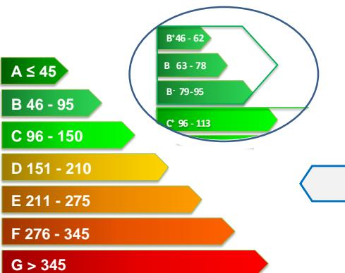
De energieklassen worden weergegeven op een schaal met pijlen, elk aangeduid met een letter van A tot G. Klasse A verbruikt minder energie dan klasse G.
